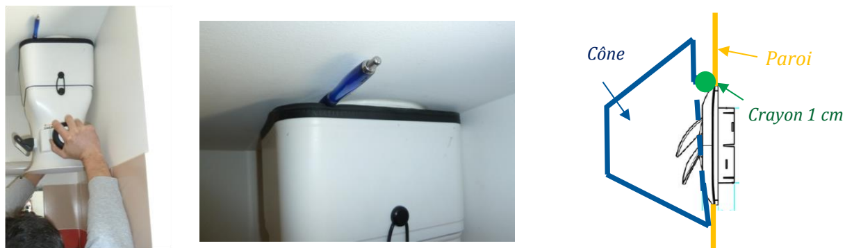
Figure 18 : Illustrations des fuites volontaires entre le cône de mesure et la paroi
