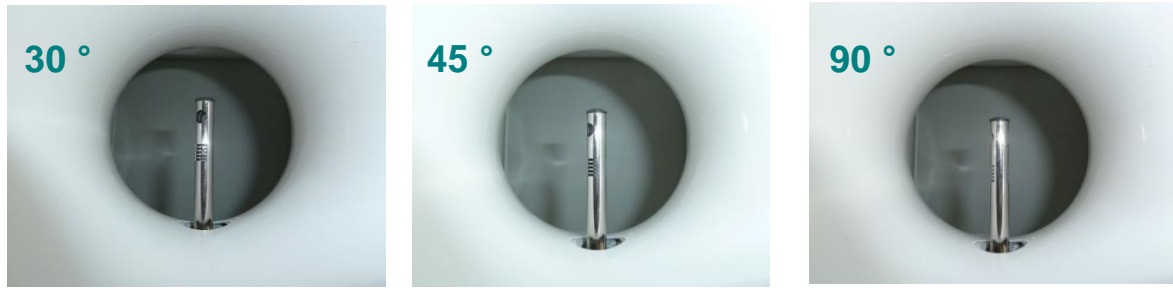
Figure 16 : Angles de rotation de l'anémomètre thermique ponctuel
